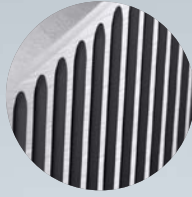
Gravure laser Finition de surface réduite à Ra 1,0 µm
