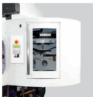
Zásobník nástrojů HSK-A/T100: 30 nástrojů HSK-A/T63: 45 nástrojů
