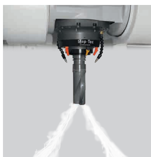
Vnitřní chlazení nástroje
