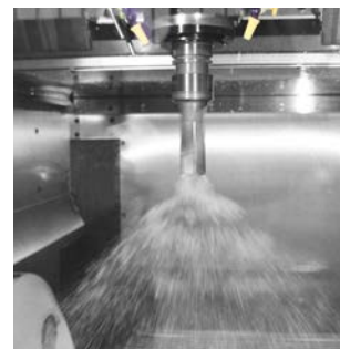
Adduzione refrigerante all'interno dell'utensile
